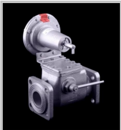
Клапаны предохранительные запорные КПЗ-50Н(В), предназначены для автоматического непрерывного контроля и отключения подачи газа по ГОСТ 5542-87 к потребителю при аварийных повышении или понижении выходного давления сверх допустимых заданных величин. Клапаны устанавливаются на газопроводах низкого и среднего давления.
