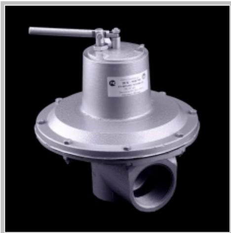
Клапаны предохранительные сбросные ПСК-50НС/В предназначены для ограничения давления неагрессивных газов, путем сброса в атмосферу до установленной величины, при повышении давления сверх допустимого предела. Клапаны устанавливаются на газопроводах низкого, среднего и высокого давления. Условия эксплуатации клапанов соответствуют климатическому исполнению У2 по ГОСТ 15150-69 с температурой окружающей среды от минус 40°C до +45°C.
